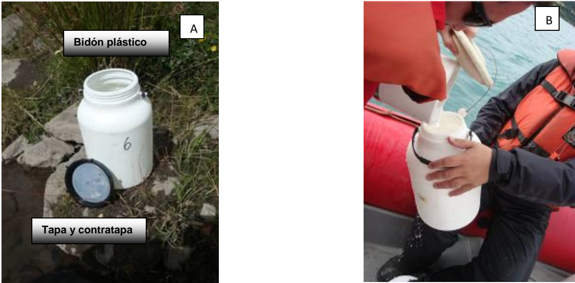
Figura 4: A) Bidón plástico de 10 litros correctamente rotulado, con su tapa y contratapa; B) Vaciado del agua desde la botella Van Dorn al envase plástico de 10 litros.
