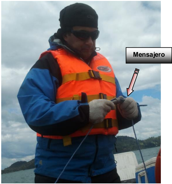
Figura 3: Forma correcta de colocar el mensajero
